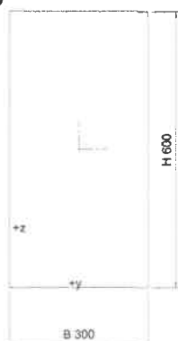
OBD (600,300), Průřez č. 1 - OBD (600,300), Materiál : 6 - B 20
